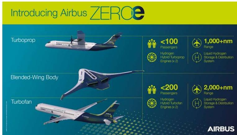
Tutti i velivoli sono caratterizzati da propulsori turboprop/turboprop ibridi alimentati ad idrogeno.
